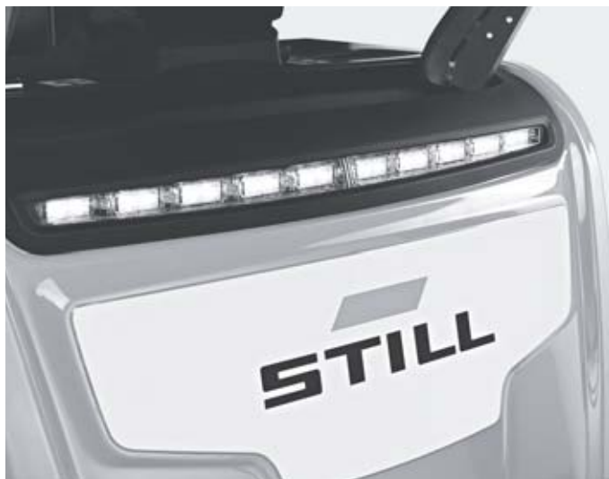
Inteligentne światło do jazdy dziennej LED zwiększa widoczność pojazdu i sygnalizuje niski poziom naładowania akumulatora
