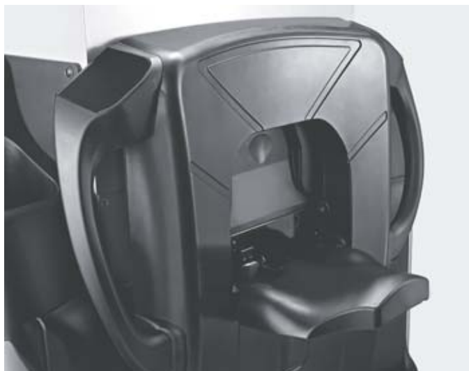
Opcjonalne składane siedzenie dla większego komfortu jazdy na dłuższych odcinkach
